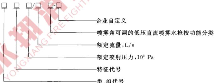
型号中的额定流量除了喷雾水枪为喷雾流量外,其余均为直流流量。对于第Ⅲ类低压直流喷雾水枪,最大流量刻度值示为额定流量;对于第Ⅳ类低压直流喷雾水枪,最大直流流量示为额定流量。
